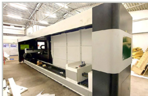
Kuvassa G-Weike LF3015GAR yhdistelmä laserin putki puoli, ovet ovat vielä asentamatta, antaa käsitystä koosta, kone on yli 9 m pitkä, 3,85m leveä ja vajaa 5m korkea, eli pienen omakotitalon kokoinen.
