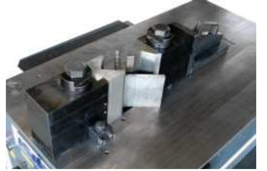
Opsiyonel boru bükme aparatı ve kalıpları Optional pipe bending attachments and tools
