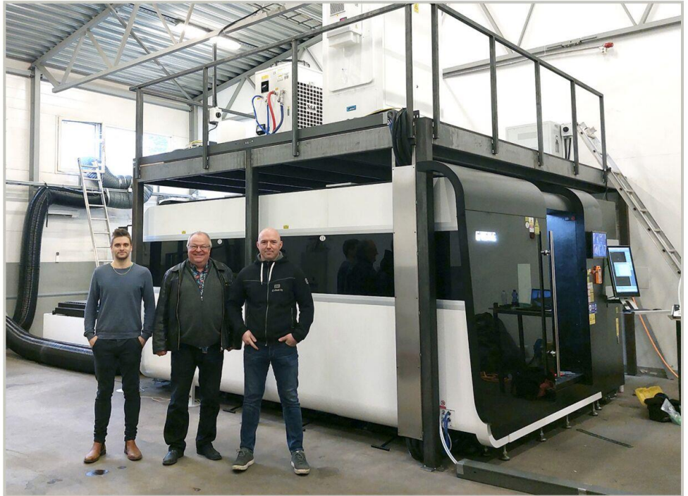
G-Weike LF3015GAR putki- ja tasolaserin edessä oikealla Konstantin Jasnov KJ-Steel, keskellä Vesa Sirén Rensi ja hänen vieressään Joni Niittymäki Rensi. Ohjauskaappi, laser yksikkö, jäähdytyn ja jännitteen tasasuuntaaja ovat asennetut koneen katolle 2. kerroksen lattia tilan säästämiseksi.
