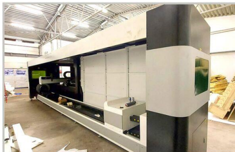
Kuvassa G-Weike LF3015GAR yhdistelmä laserin putki puoli, ovat vielä asentamatta, antaa käsitystä koosta, kone on yli 9 m pitkä, 3,85m leveä ja vajaa 5m korkea, eli pienen omakotitalon kokoinen.
