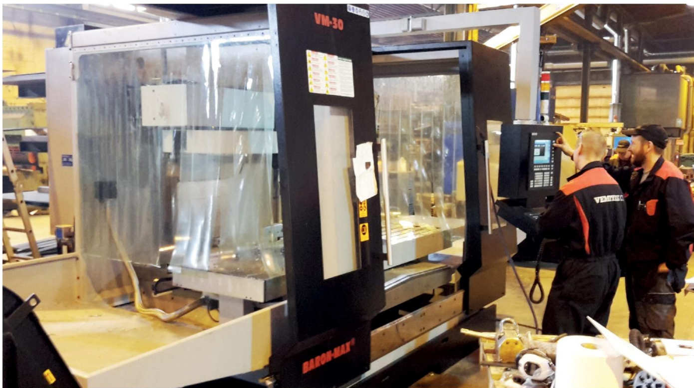
Vaativuoksena oli toinen BaronMax VM30 -kone 1500x850 mm työalalla ja erikoissuurella karamoottorilla, jotta pystytään poraamaan 50 mm reikiä teräkseen. Kuvassa Vemitek Oy:n Tero Mäntykoski ja Tuomas Sepponen.
