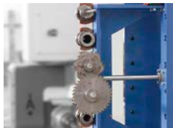
Magazynek listwowy na 6 narzędzi, mocowany na kolumnie bramy 6-tool slatted magazine mounted on the gantry column
