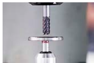
FDL1 Sonda pomiaru długości narzędzia pozwala nanieść poprawki do programu obróbczego. The tool length probe allows application of a correction to the machining program.
