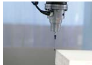
TS230 Sonda przewodowa do pomiaru detalu. Wired probe for component measuring
