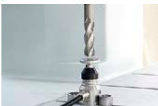
TT160 Sonda pomiaru długości i średnicy narzędzia. Wynik pomiaru jest automatycznie nanoszony jako poprawka do programu/kodu ścieżki narzędzia Probe for measuring tool length and diameter. The measurement result is automatically applied as a correction to the program/code for the tool path
